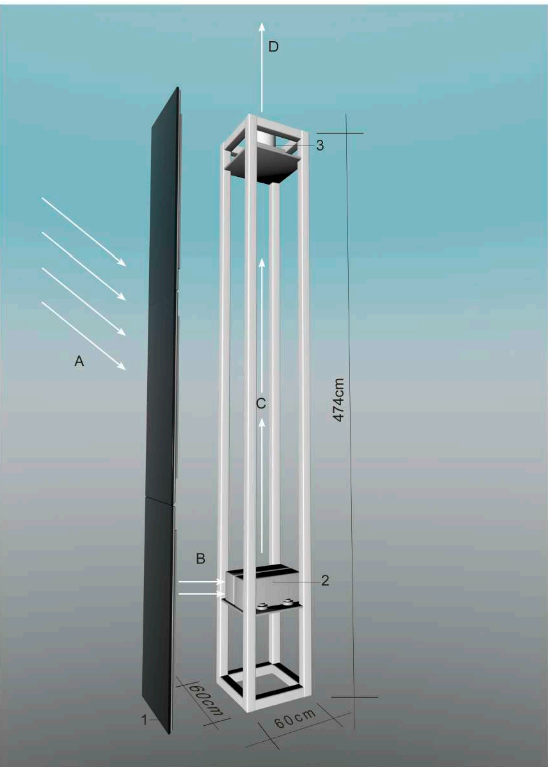
Abb. 8 Prozess der Entstehung des Laserstrahls: A - Einfangen des Lichtstrahls, B - Leitung zum Akkumulator, C - Leitung zum Laser, D - Laserstrahl 1. Solarpanel, 2. Akkumulatoren, 3. Laser
